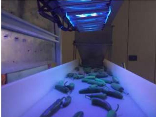
Figura 8. Proceso de desinfección con luz UV-LED
